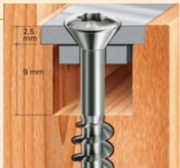
La parte lisa del vástago no interfiere con el movimiento del sistema, incluso con atornillado inclinado.
