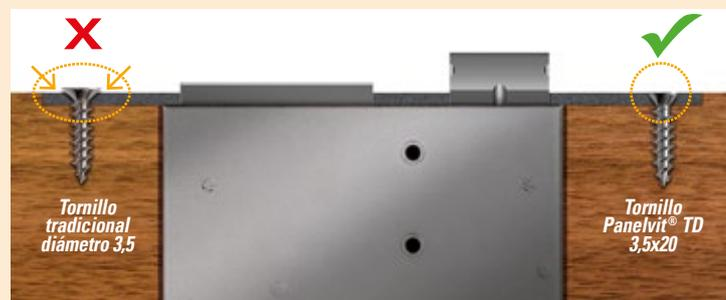
**La cabeza reducida** permite utilizar un tornillo de un diámetro superior (3,5) que **garantiza una resistencia mayor** sin que la cabeza salga por el agujero.
