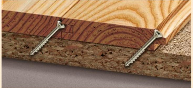
**Cabeza reducida con estrías bajo cabeza y mortaja TX** que fresa y evita que la madera se agriete en fase de cierre. **La cabeza entra totalmente en la madera para permitir la colocación del listón siguiente.** La mortaja TX transmite la fuerza de apriete y evita el deslizamiento de la punta y el desgaste de la cabeza.
