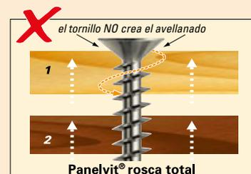
La rosca actúa de la misma manera en las dos partes, evitando que la parte inferior (2) se acerque a la parte superior (1) y que se obtenga el apriete.
