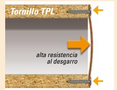
**La punta ojival, con la rosca hasta el extremo**, penetra en el material, lo deforma gradualmente **sin hendirlo** y evita que se estropee el laminado del acabado.
